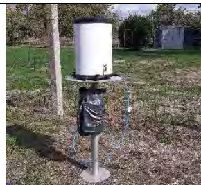
Pluviographe avec enregistreur
